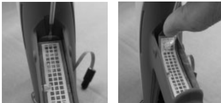
Obrázek 6-8 Demontáž spínače spouště z rukojeti
