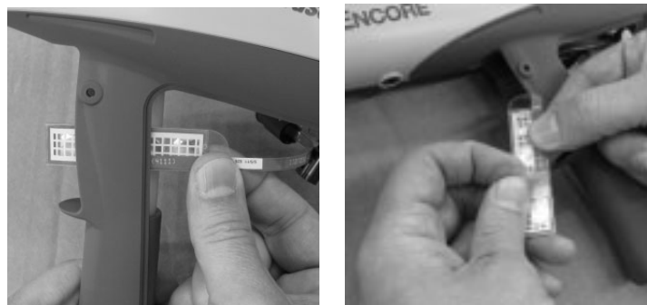
Obrázek 6-9 Instalace spínače spouště - kroky 1 a 2
