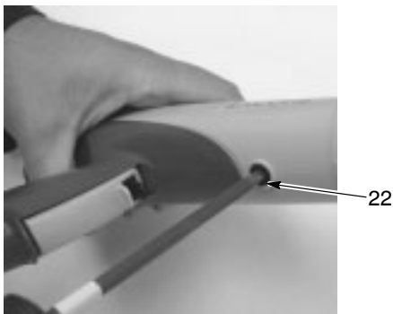
Obrázek 6-2 Demontáž tělesa pistole z rukojeti
